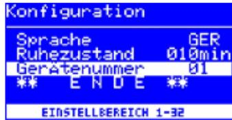
Diese Funktion wird nur dann benötigt, wenn die i-CON 1 mit der seriellen PC-Schnittstelle (Option) ausgerüstet ist. Damit der PC die angeschlossene Station korrekt zuordnen kann, müssen Sie zur Identifizierung eine eindeutige Gerätenummer einstellen.
