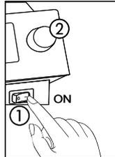
Das Ein/Ausschalten der Lötstation erfolgt mit dem Netzschalter auf der Frontseite ①.
