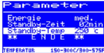
Dies ist die Lötspitztemperatur bei Arbeitspausen. Sie wird automatisch nach Ablauf der [Standby Zeit] aktiviert. Durch das Absenken der Temperatur wird Energie gespart und die Lebensdauer von Spitze und Heizkörper erhöht.
