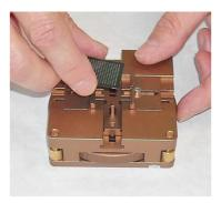
Setzen Sie den BGA in den stufenlos verstellbaren Bauteilhalter ein. Die minimale Bauteilgröße beträgt 4x4mm. Die maximale Bauteilgröße beträgt 45x45mm.
