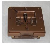
Die Reballing-Station besteht aus insgesamt drei Teilen. Die Teile **a** und **b** bilden den zweiteiligen Rahmen für die Schablonen. Es passen sowohl 80x80mm als auch 90x90mm Schablonen hinein. Teil **c** ist der Bauteilhalter.
