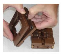
Die Rahmenteile **a** und **b** sind durch Magnete miteinander verbunden und können ohne zusätzliches Werkzeug getrennt werden.
