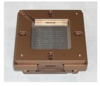
Sind die Löcher der Schablone nicht deckungsgleich mit den Pins des BGAs, muss die Schablone entsprechend verschoben werden. Anschließend werden die Teile zusammengeschraubt.
