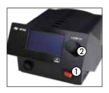
Das Ein/Ausschalten der Lötstation wird durch den auf der Frontseite befindlichen Schalter ① ausgeführt. Wenn die Lötstation eingeschaltet ist, leuchtet der Schalter rot. Die Bedienung der Lötstation erfolgt durch einen Drehgeber ② mit Tastfunktion (Druckfunktion). Dieser trägt den Namen i-OP. Der i-OP ermöglicht es, gewünschte Funktionen auszuwählen oder Werte zu verändern.
