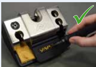
Lötspitzen leicht in die Metallwolle einstecken und drehen
