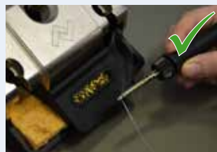
Nach Reinigung neues Lot zuführen
