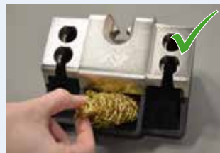
Verschmutzte Metallwolle entfernen, Lotauffangbehälter leeren
