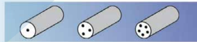
Lötdraht mit einer bzw. mehreren Flussmittelseelen
