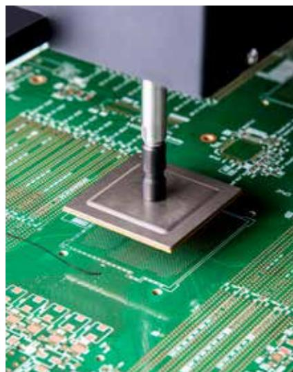
Handling eines metallischen BGA
