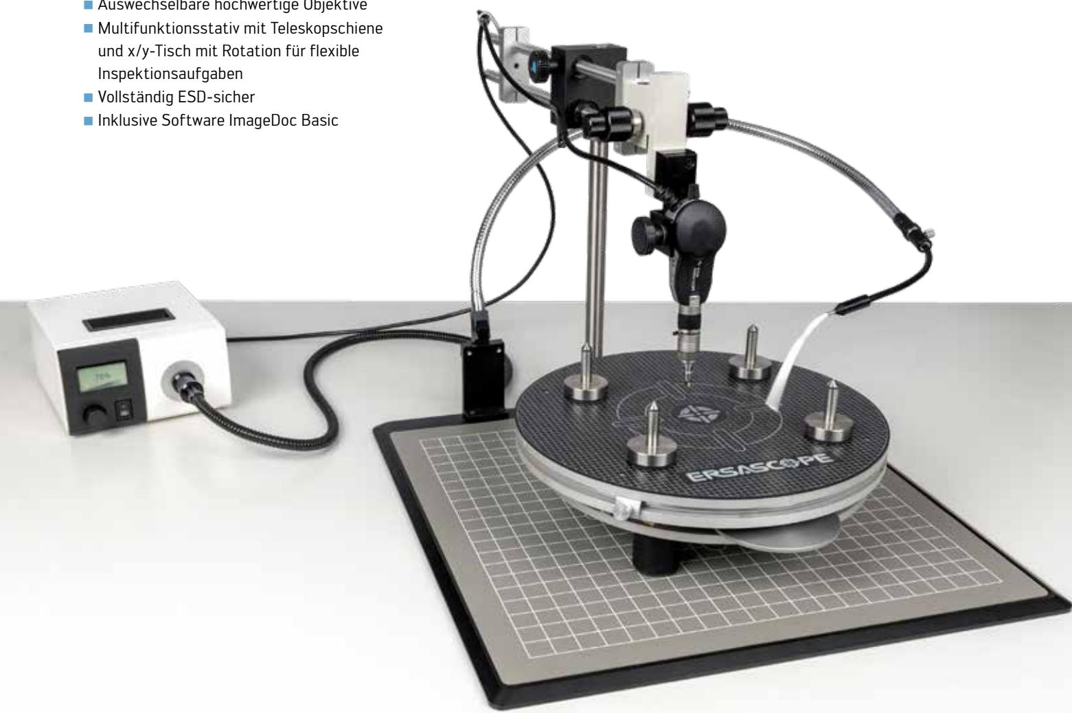
Das ERSASCOPE X ist ein Inspektionsvideomikroskop zur Analyse verdeckter Lötstellen in der Elektronikfertigung. Es dient der visuellen Inspektion und digitalen Bildaufnahme, insbesondere für Lötstellen an BGAs und anderen SMT-Bauteilen, einschließlich der Messung von Lötstellen. Außerdem lässt es sich zur optischen Kontrolle von Leiterplattenflächen und Lotpastendrucken verwenden. Einsatzgebiete sind in der Qualitätssicherung, Produktion, Labor und Forschung.
