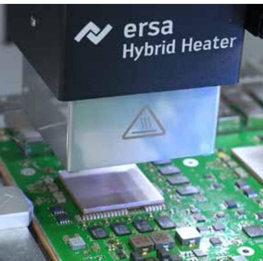
Hybrid-Heizkopf beim Entlöten eines metallischen BGA
