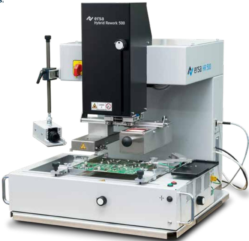
Das Ersa HR 500 Hybrid Rework-System deckt gängige Rework-Aufgaben wie das Entlöten, Platzieren und Einlöten von QFP, BGA sowie MLF und zweipoligen Bauteilen bis 1 x 1 mm an mittelgroßen SMD-Baugruppen ab.
