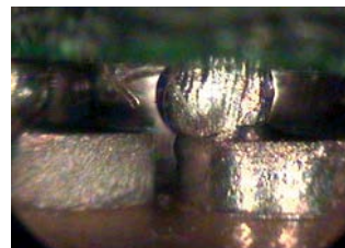
BGA: schlechte Ausrichtung
