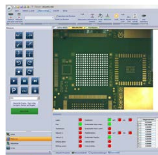
Überlagern von Bauteil und Zielposition
