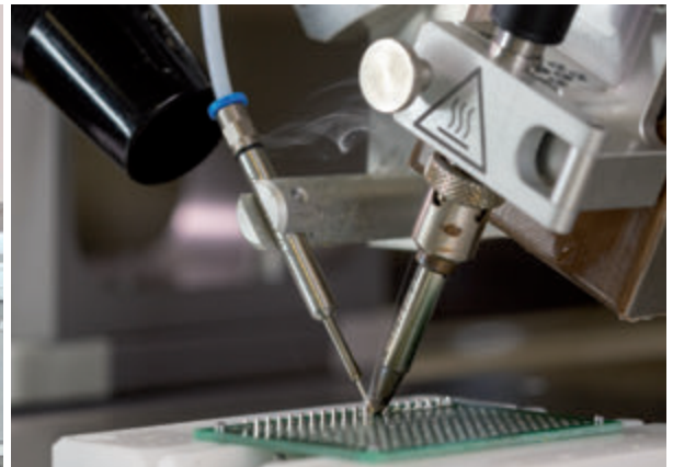
Leistungsstarker i-TOOL mit präziser Löt drahtzuführung und integrierter Absaugvorrichtung für den Löt Rauch
